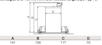
Schauglas mit Verschraubung auf Basis von DIN 11851 mit miniVISION Typ 70.
