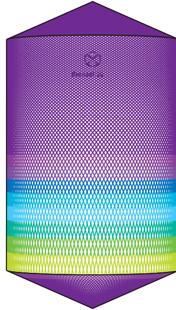
T 2 m, H 3 m, Toftejorg SaniJet 20, 4 x ø4,2 , Zeit = 7,6 Min., Wasserverbrauch = 763 l
