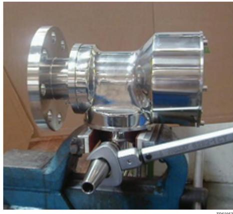
Durch Einsetzen eines 3/16" Inbusschlüssels überprüfen, dass die Maschine in Betriebszustand ist (Werkzeugnr. TE134A) in die Schraube am oberen Ende der Turbinenwelle und langsames Drehen der Welle im Uhrzeigersinn. Beim geringsten spürbaren Widerstand muss die Maschine zerlegt und die Ursache lokalisiert werden.
