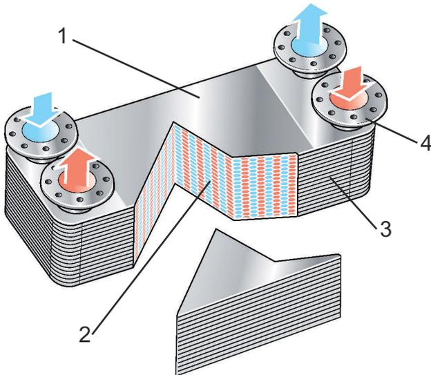
Abbildung 1: Funktion: Endplatte (1), Kanalplatten (2), Blindplatte (3) und Anschlüsse (4).
